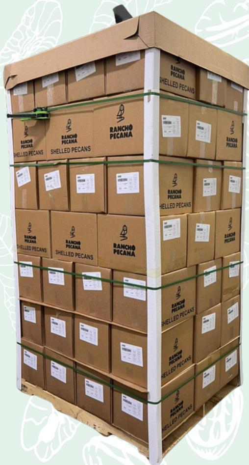
Paletizado en una tarima GMA estándar de 48"x40" con un patrón de apilamiento de 10 cajas por capa por 7 cajas de alto, columna y patrón de apilamiento escalonado.
