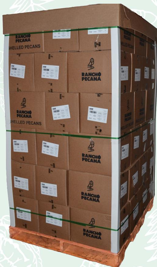
Paletizado en una tarima GMA estándar de 48"x40" con un patrón de apilamiento de 10 cajas por capa por 6 cajas de alto, columna y patrón de apilamiento escalonado.
